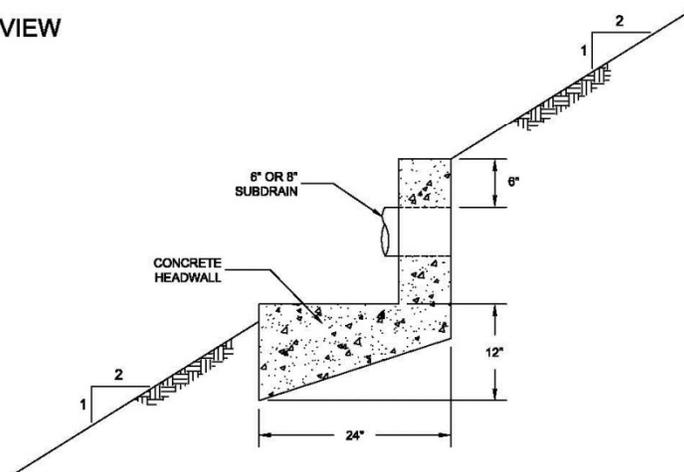
NOTE: HEADWALL SHOULD OUTLET AT TOE OF FILL SLOPE
