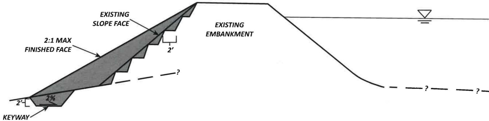
**B) LAY EXISTING OUTBOARD SLOPE FACE BACK TO CREATE 2:1 SLOPE; ADD FILL TO INBOARD FACE**
