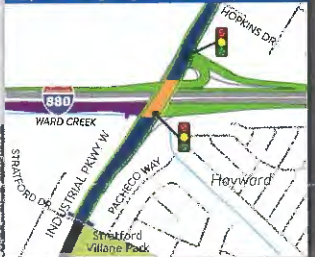
Alternativa 3 - Híbrido de diamante apretado y hoja de trébol parcial
