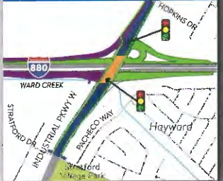
Alternativa 2 - Híbrido de diamante apretado y hoja de trébol parcial
