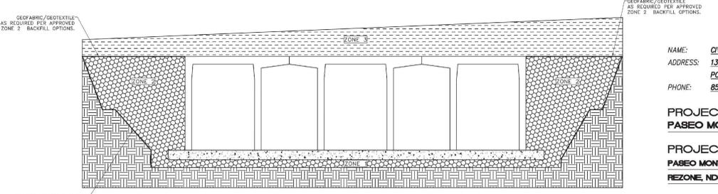
**STORMTRAP - BACKFILL DETAIL**
