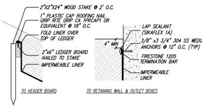
**IMPERMEABLE LINER ATTACHMENT DETAIL**
