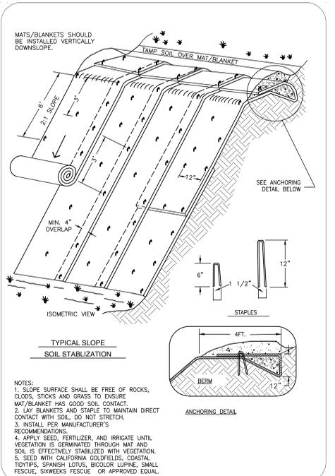
5 JUTE NETTING EROSION CONTROL MAT NTS
