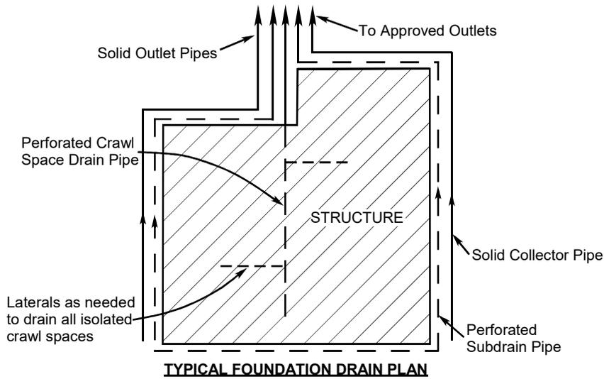
**TYPICAL FOUNDATION DRAIN PLAN**
