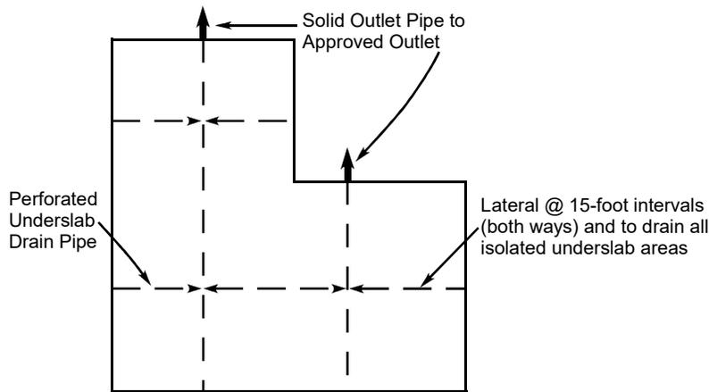
**TYPICAL UNDERSLAB DRAIN PLAN**
