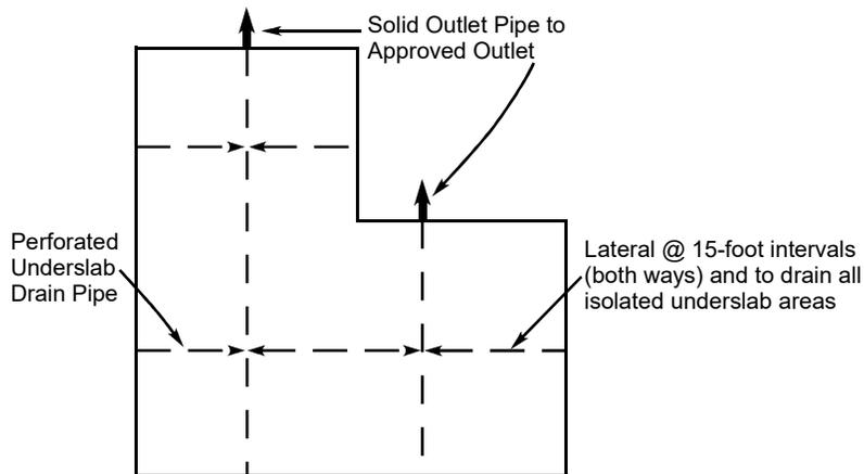
**TYPICAL UNDERSLAB DRAIN PLAN**
