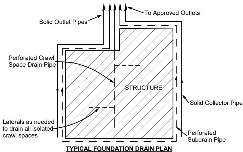
**TYPICAL FOUNDATION DRAIN PLAN**
