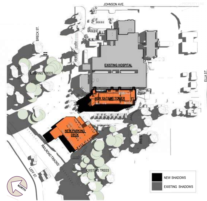
1 Site Plan Solar Study - Fall Equinox 9AM A304 1:1500
