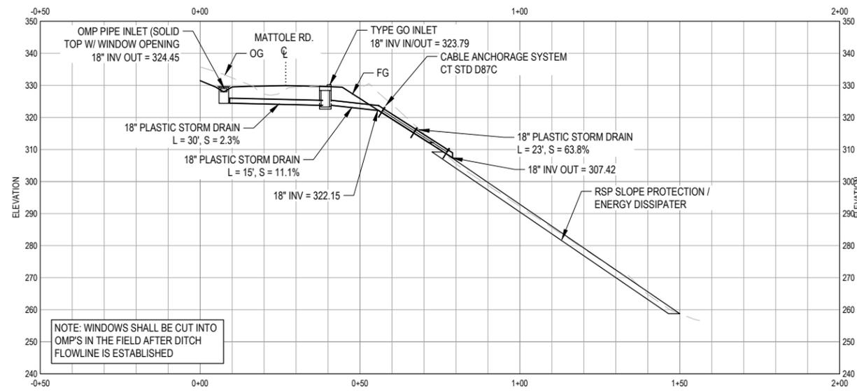
**DRAINAGE PROFILE - DRAINAGE SYSTEM 2**
