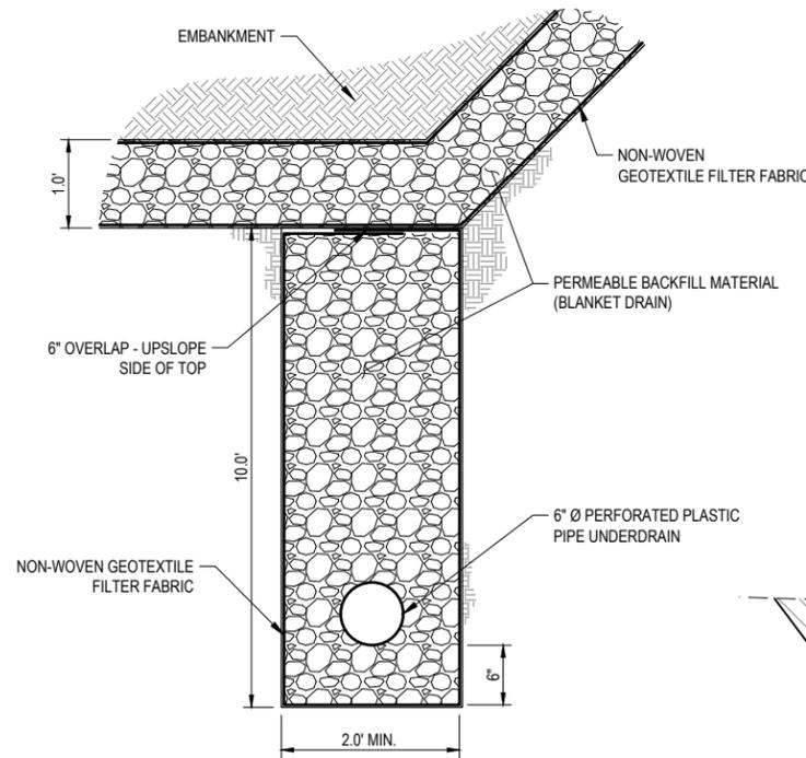
TYPICAL TRENCH UNDERDRAIN (SUBDRAIN) & BLANKET DRAIN
