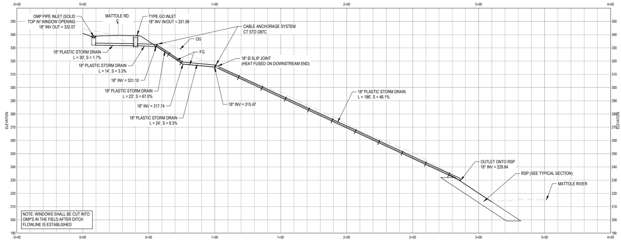
**DRAINAGE PROFILE - DRAINAGE SYSTEM 1**
