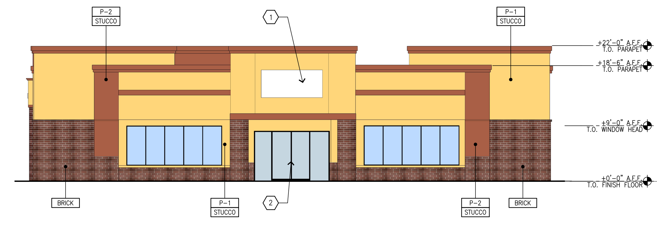
A SOUTH C-STORE ELEVATION SCALE: 1/8"=1'-0"
