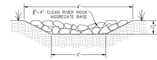
**TYPICAL ROCKED SWALE DETAIL**
