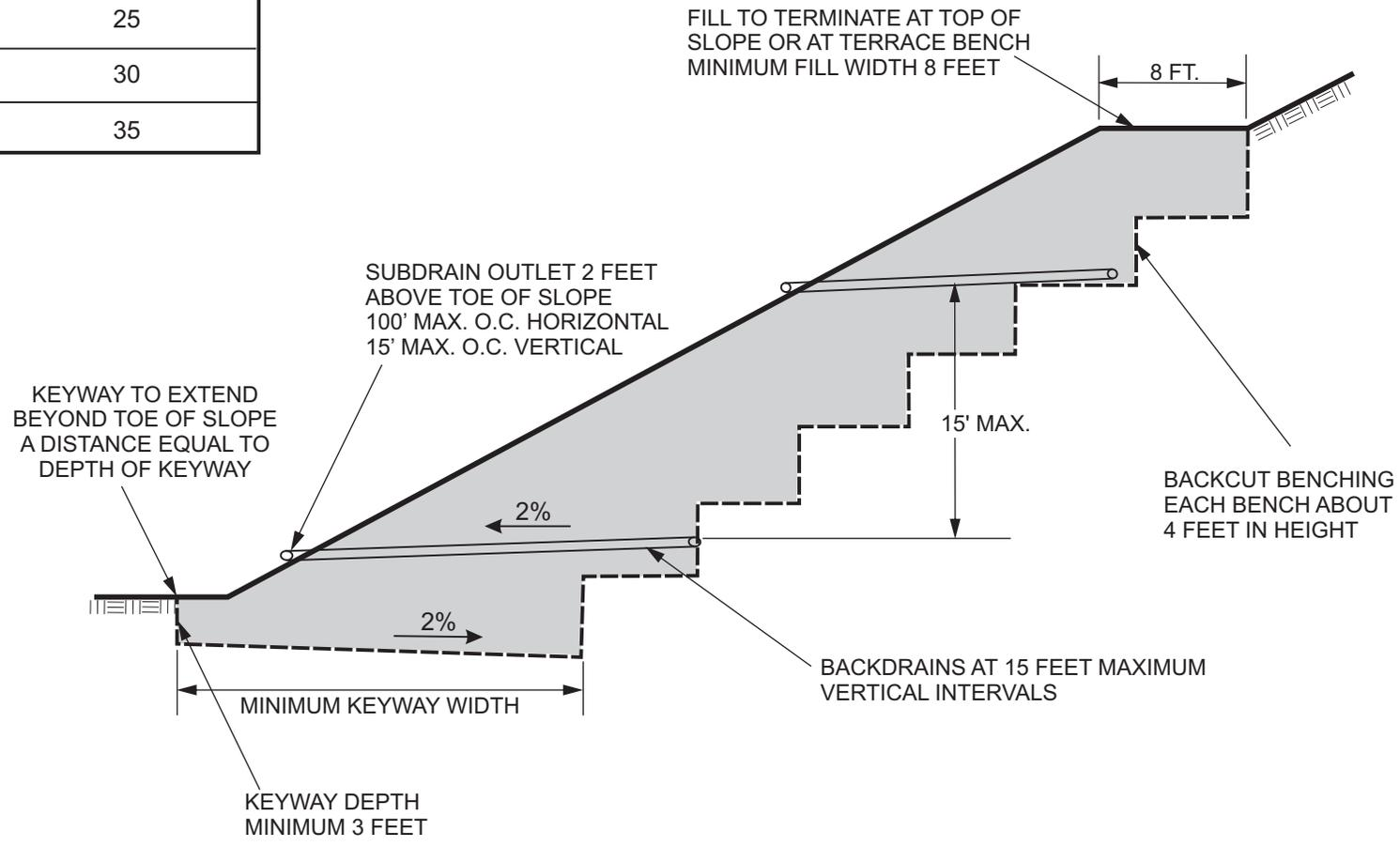
**STABILITY FILL DETAILS FOR GROSSLY STABLE SLOPES**
