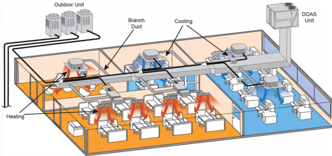
Figure 2 VRF Schematic
